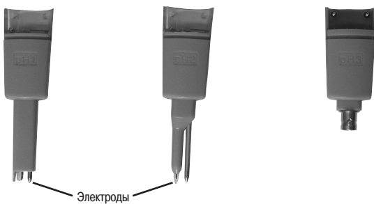
Погружной pH- зонд (pH1)
