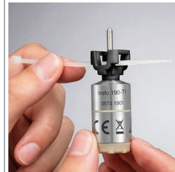
3 Крепежный материал (кабельная стяжка, проволока и т.д.) можно пропустить через отверстия зажима.
