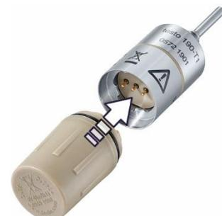
2 Зафиксируйте батарею, повернув её по часовой стрелке.
