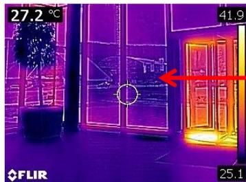
Функция MSX отображает на термограмме контуры и границы зданий за окном, хотя тепловизор не может измерять сквозь стекло
