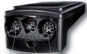
Канал 1: температурный зонд Тип K/J/S, NTC
