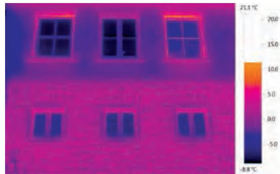
Термограмма с функцией testo ScaleAssist
