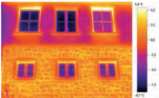
Термограмма без функции testo ScaleAssist
