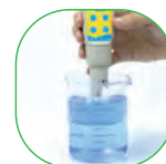
Шаг 1: погрузите сенсор прибора в раствор
